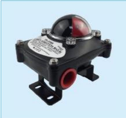
TPL阀门限位开关是自控系统中检测阀门状态的一种现场仪表，用以将阀门的开启或关闭位置以开关量（触点）的信号输出，被程控器接收或计算机寻访采样，确认后执行下一步程序。该产品也可作为自控系统中重要阀门连锁保护及远程报警指示之用。
